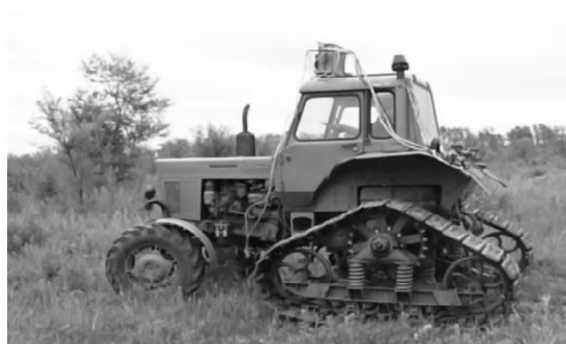
Рис. 3. Рабочие фрагменты испытаний трактора МТЗ-80 с треугольным металлогусеничным движителем
