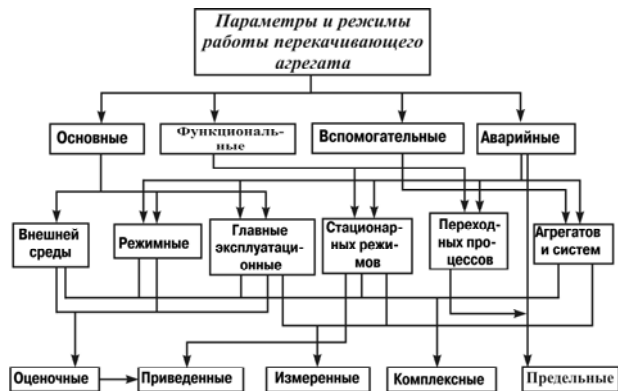
Рис. 1. Основные параметры, характеризующие работу перекачивающего агрегата
